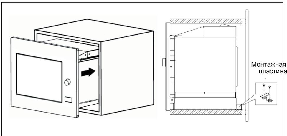
5. Откройте дверцу, прикрепите печь к шкафу с помощью винта в установочном отверстии. Затем прикрепите пластиковую наклейку к монтажному отверстию.
