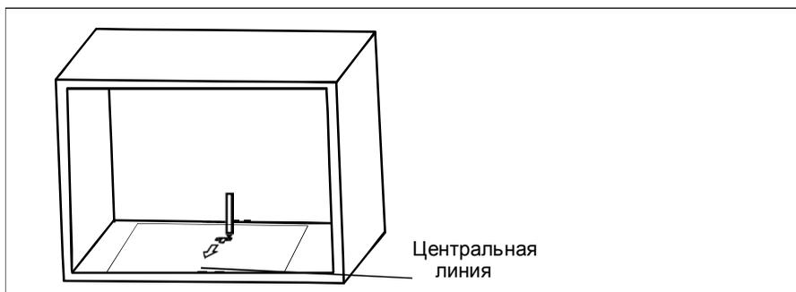
3. Снимите шаблон и закрепите монтажную пластину винтом.
